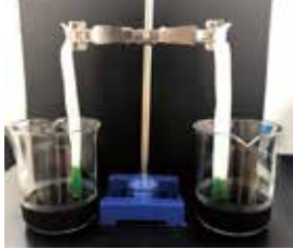
吸水度試験方法 JIS:8141 2004紙及び板紙-吸水度試験方法-に準ずる
